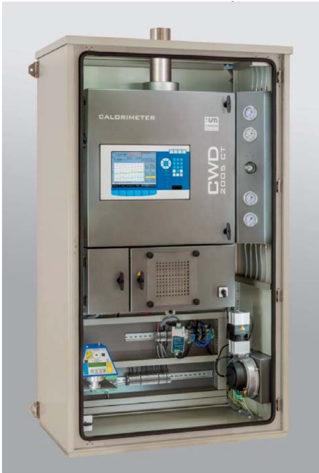
Das EMS2005 (Energy Measuring System) von Union Instruments zur Bestimmung des Energieinhalts von brennbaren Gasen besteht aus einem CWD2005, einer Durchflussmessung und einem Umwerter.
